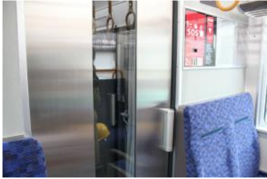
車両間を行き来するための貫通扉を開けやすくする工夫
